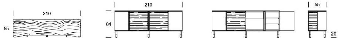
Ante curve rivestite in pelle sia all'interno che all'esterno. Mobile realizzato in legno liscellare interamente impiallacciato in Ebano Emara finitura 100% Gloss, nelle due ante centrali, all'interno e sul retro del mobile. Top in marmo Volakas dallo speciale disegno senza angoli acuti nella parte frontale.
